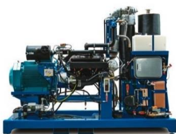
Slika 32: Manjša naprava za soproizvodnjo na les z uplinjanjem s tehničnimi podatki 56
